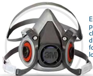
El respirador 6100DD de 3M(MR) brinda protección contra partículas, vapores orgánicos, cloro, ácido clorhídrico, fluoruro de hidrógenos, dióxido de azufre, amoníaco, metilaminas, formaldehído y radio nucleídos, dependiendo de los cartuchos y filtros.
