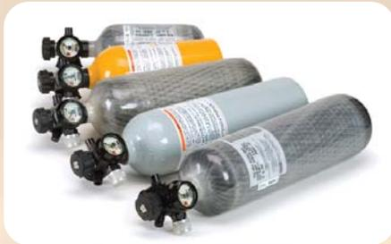
MSA ofrece la opción de tres cilindros de baja presión para 30 minutos (2,216 psig) para usarse con el AirHawk II. Elija carbón, fibra de vidrio o cilindros fabricados totalmente en aluminio. Cilindros de alta presión (4,500 psig) de carbón están disponibles en duraciones de 30, 45 ó 60 minutos.
